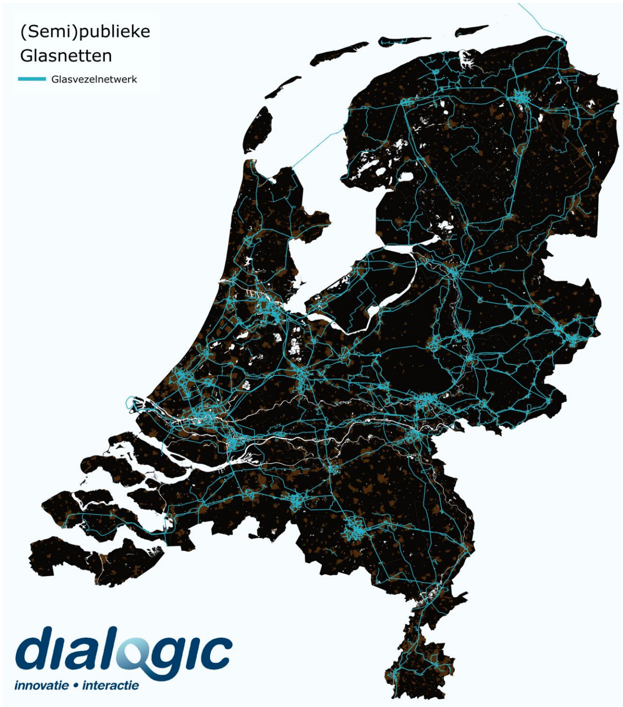
Figuur 4. Overzicht geïdentificeerde (semi)publieke glasvezelnetwerken waarvan de ligging openbaar is of gedeeld kan worden
